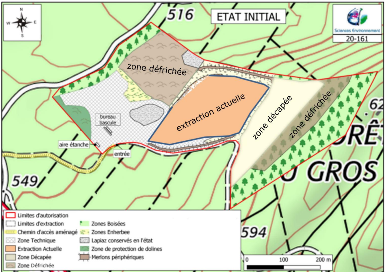
Figure 8 : Plan schématique de la carrière actuelle
