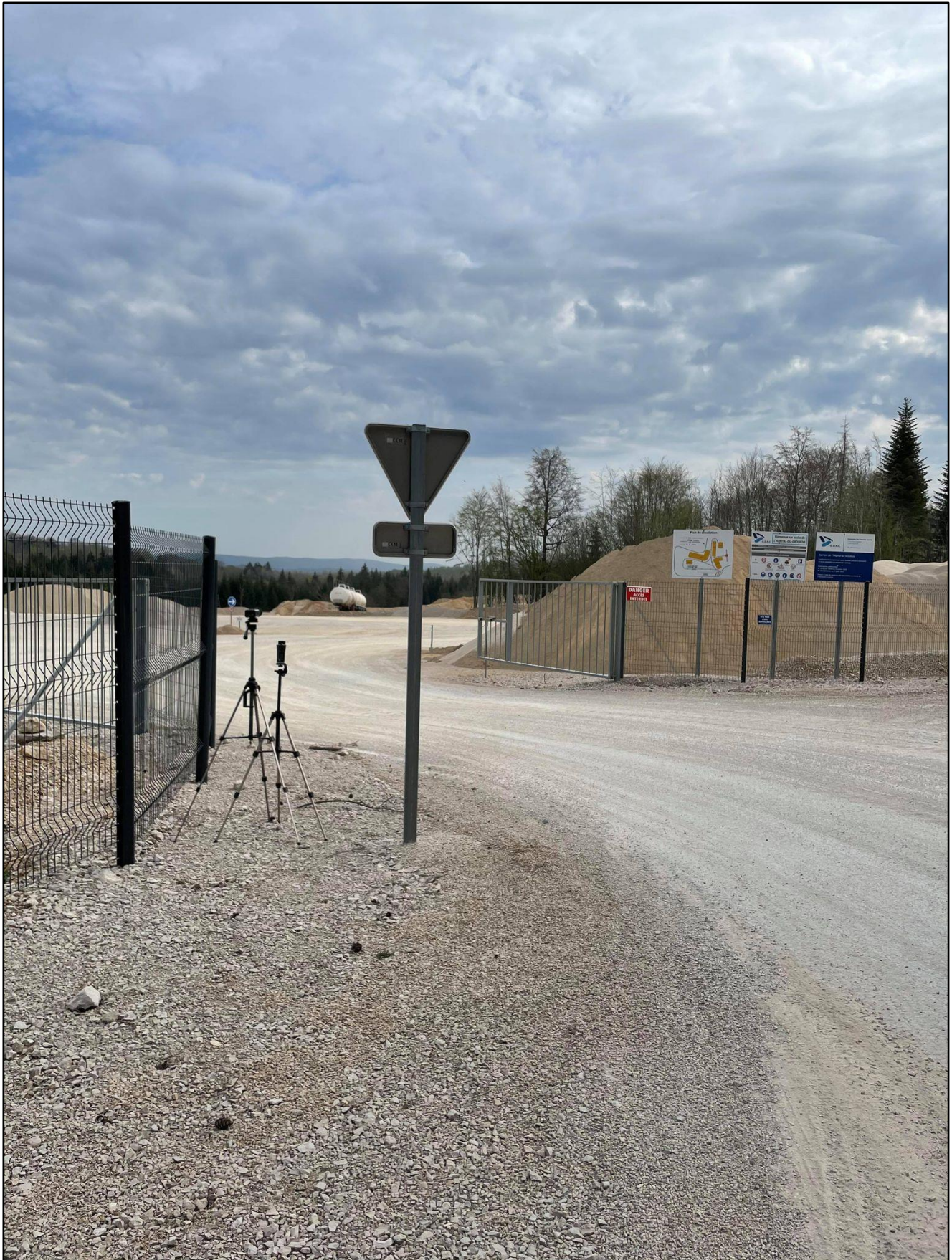
Figure 7 : Photographie du sonomètre lors de la mesure du niveau sonore en limite de site (point LIM-1 sur la Figure 1).
