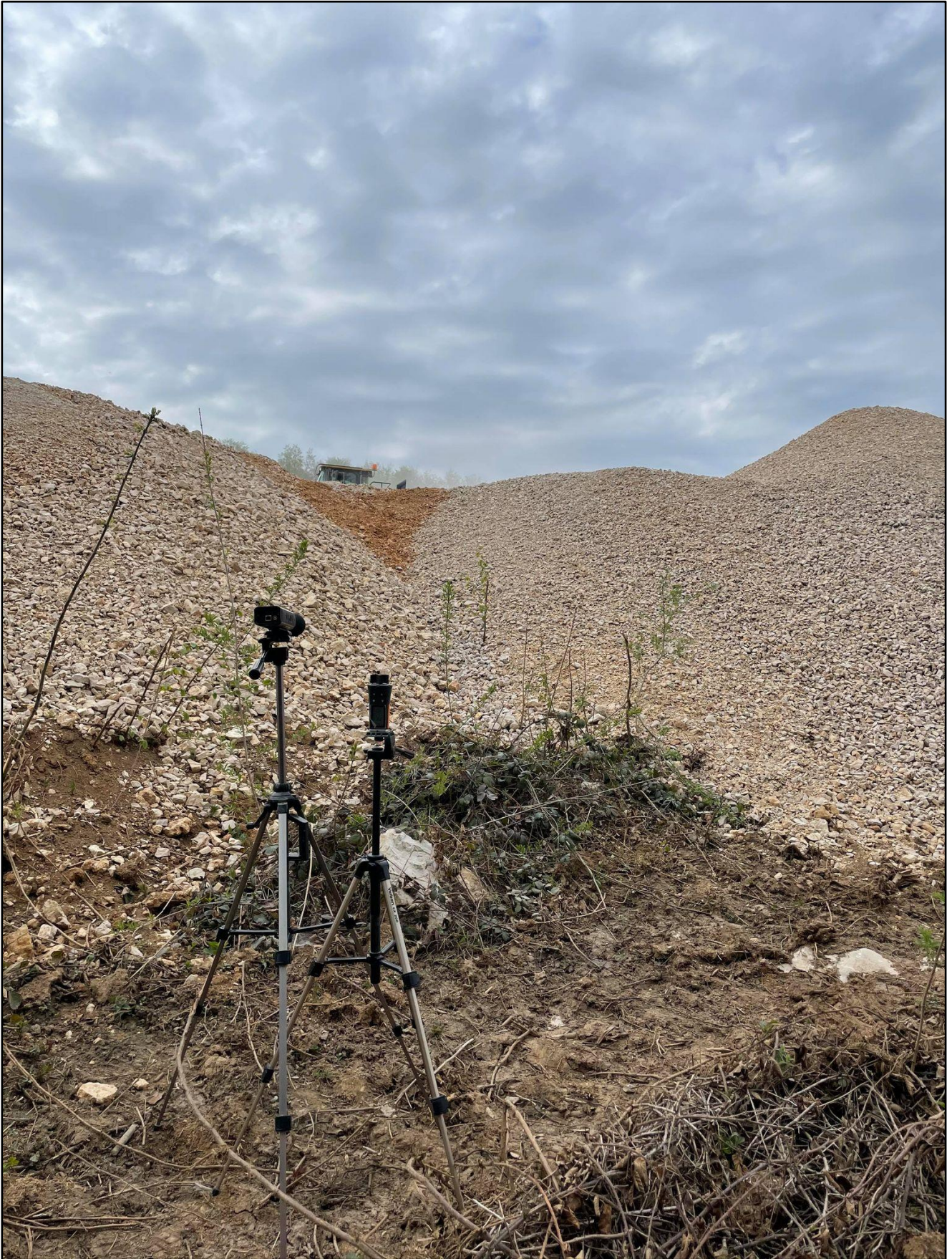
Figure 8 : Photographie du sonomètre lors de la mesure du niveau sonore en limite de site (point LIM-2 sur la Figure 1).
