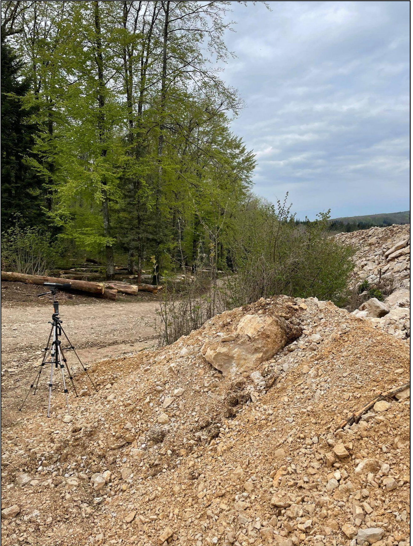
Figure 9 : Photographie du sonomètre lors de la mesure du niveau sonore en limite de site (point LIM-3 sur la Figure 1).
